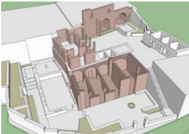
Σχέδιο 1. Τα σκιασμένα μέρη του προοπτικού σχεδίου υποδεικνύουν τον αρχικό διώροφο πυρήνα του κτιρίου.
